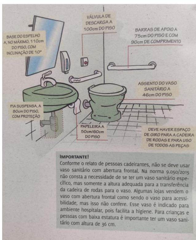
Figura 6: Orientações para a construção de um banheiro acessível a pessoas com deficiência física
